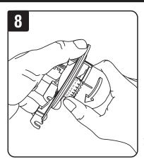
Retire el tapón de la válvula para descarga de inodoro jalando lentamente el marco del tapón.
