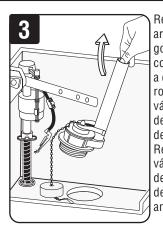
Retire la arandela de goma y la contratuerc a de las roscas de la válvula para descarga de inodoro. Retire la válvula para descarga de inodoro antigua.
