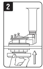
Coloque la empaquetadura aue une el tanque a la taza nueva sobre la tuerca, con el lado angosto hacia abajo. La empaquetadura debe cubrir completamente la tuerca.
