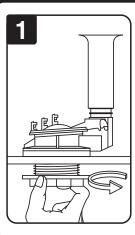
Retire la empaquetadura que une el tanque a la taza y la tuerca de la parte inferior de las roscas de la válvula para descarga de inodoro nueva antes de instalarla en el tanque. Coloque el tubo de desborde hacia la parte posterior del tanque pero no sobre los orificios de los pernos. Enrosque la tuerca grande en las roscas. Apriete a mano solamente. NO APRIETE DEMASIADO ya que el tanque podría agrietarse.
