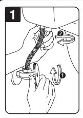
Corte el suministro de agua (1). Descargue el inodoro y retire el exceso de agua del tanque con una esponja. (2) Retire la tubería del suministro de agua de la parte inferior de la válvula de llenado del inodoro.
