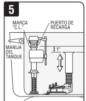
Una vez instalada, la parte superior de la tubería de desborde de la válvula de descarga debe estar al menos 2.5 cm (1 pulg.) por debajo de la marca de nivel crítico (C. L.) de la válvula de llenado.
