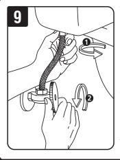
Vuelva a conectar la línea de suministro de agua a la parte inferior de la válvula de llenado. Aiuste a mano la tuerca plástica de la línea de suministro al vástago de la válvula de llenado. NO LA AJUSTE EN EXCESO. 吕 (1). Abra el suministro de agua y busque posibles pérdidas (2). Si no hay SOLUCIÓN pérdidas, réalice una descarga de prueba. Si hay pérdidas, ajuste la tuerca justo lo suficiente para eliminar las pérdidas.
