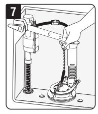
Conecte la cadena del tapón a la palanca del tanque. Asegúrese de que la cadena tenga 1,27 cm de holgura cuando el tapón esté en la posición de cerrado.
