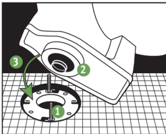
Para tazas de inodoro con la salida en el piso. Listo para el uso a 21,1°C de temperatura. No se endurecerá o deteriorará. Forma un sello resistente a gas, olor y agua.
