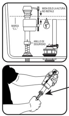
Coloque la válvula de llenado en el tanque, pero todavía no la instale. La parte superior de la válvula de llenado debe estar a 7,62 cm por sobre la tubería de desborde. Esto ubicará automáticamente la **MARCA DE NIVEL CRÍTICO (C.L.)**. Marque 2,54 cm por sobre la parte superior de la tubería de desborde. Retire la válvula de llenado del tanque para ajustar la altura.
