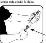
Aiuste la altura de la válvula de llenado al sostener el vástago inferior con la mano derecha
