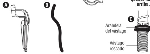
Coloque la arandela del vástago sobre el vástago roscado de la válvula de llenado. El lado plano debe quedar hacia arriba.
