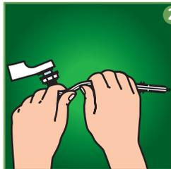
**2** Para tanques de montaje estándar vaya al paso 3. Para **TANQUES DE MONTAJE LATERAL O EN ANGULO**, doble lentamente el brazo de la palanca para hacer coincidir con la forma del brazo viejo de la palanca. **NO DOBLE EL BRAZO RÁPIDAMENTE O REPETIDAMENTE HACIA AMBOS LADOS.**
