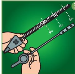
**3** Mida la longitud del brazo actual de la palanca. En caso necesario, recorte el nuevo brazo en la línea de corte que mejor se adapta a la longitud del brazo viejo (se recomienda usar una sierra de arco para obtener mejores resultados).
