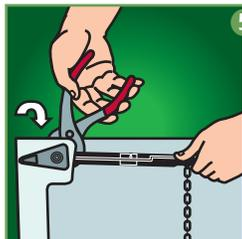
**5** Conecte la cadena del obturador/enganche con el agujero del brazo que proporciona el mejor ajuste. La cadena debería quedar un poco floja cuando el obturador está en posición de cerrado. Verifique la acción de elevación para una descarga correcta. Ajuste la tuerca de traba. **NO AJUSTE DEMASIADO**, ajustar demasiado podría rajarse el tanque.
