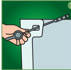
**1** Extraiga la tapa del tanque. Desconecte la cadena del obturador/enganche desde la palanca. Desenrosque la tuerca de la palanca vieja. Saque la palanca del tanque.
