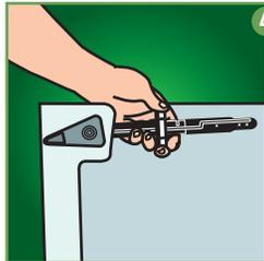
**4** Deslice el brazo a través del agujero del tanque hasta que el vástago se ajuste perfectamente. Deslice la tuerca de traba sobre la palanca (el lado liso mirando hacia la manija) Comience a colocar las tuercas (rosca inversa). **NO AJUSTE COMPLETAMENTE.**
