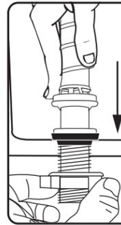
Corrija el ajuste del tubo de recarga y del sujetador de recarga en la tubería de desborde
