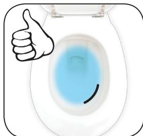
Si el nivel del agua coincide con la línea en la taza del sanitario y la válvula de llenado **TODAVÍA SIGUE LLENANDO**, entonces el nivel del agua en la taza es **DEMASIADO ALTO**, proceda al Paso 7D.
